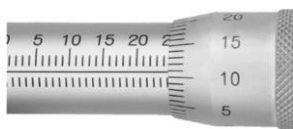
图 1-3-4 外径千分尺的刻线原理
