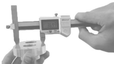
图 1-2-18 测量工件两短距孔孔距尺寸 图 1-2-19 测量工件两长距孔孔距尺寸
