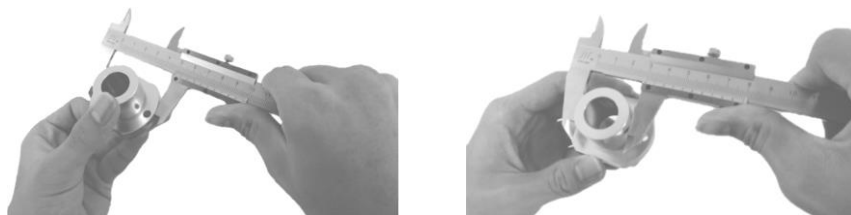
图 1-2-13 测量工件外径尺寸
