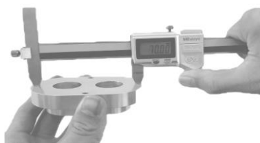
图 1-2-18 测量工件两短距孔孔距尺寸 图 1-2-19 测量工件两长距孔孔距尺寸
