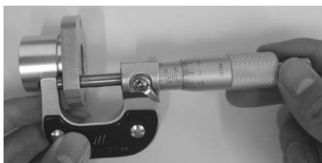
图 1-3-11 测量工件厚度
