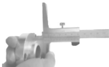
图 1-2-16 测量工件高度尺寸
