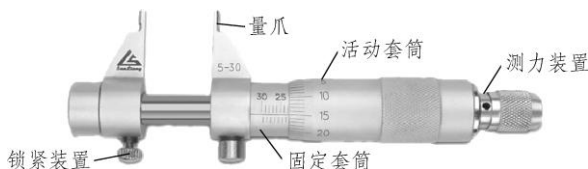
图 1-3-8 内测千分尺的构造及各部位名称
