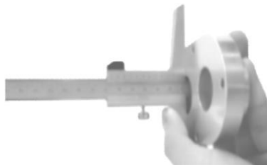
图 1-2-17 测量工件内孔深度尺寸
